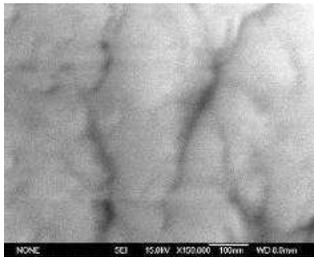
японской фирмы JEOL. Получено изображение наноструктур углерода в приповерхностном слое образца коллектора.
